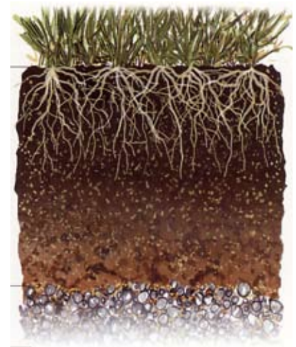
Idealaufbau: Bodenprofil mit Dränschicht und Rasentragschicht
